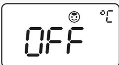
2. Halten Sie die OFF (lautlos)/ON (Signalton)-Taste für ca. **12 Sekunden** gedrückt, bis das Display „ON“ oder „OFF“ anzeigt.
