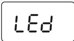
2. Halten Sie die Ein/Aus-Taste für ca. **10 Sekunden** gedrückt, bis das Display „LED“ anzeigt.
